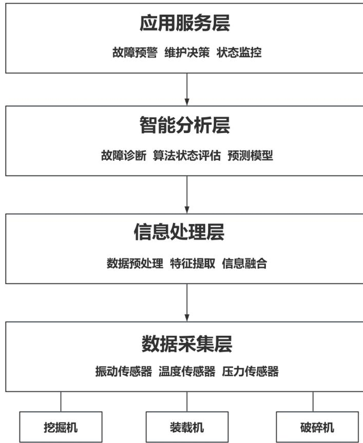
图 1 矿山大型机械设备智能诊断系统总体架构图
